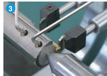
3. 웨지스크류를 회전하여 인서트 높이조절 및 백테이퍼 설치 ① 인서트 전면 : +0.015 \sim +0.020\text{mm} ② 인서트 후면 : +0.005 \sim +0.010\text{mm} ③ 백테이퍼 : 0.010 \sim 0.015\text{mm}
