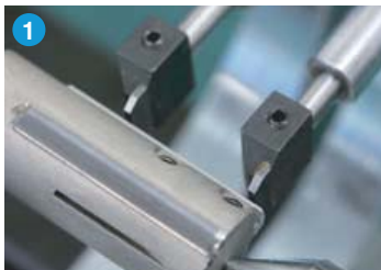
1. 양센터를 이용하여 리머고정 패드를 기준으로 게이지 0점 조절
